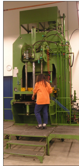
Ansicht: Pressen 1 Teile-Durchmesser bis 1000 mm Presskraft 7 t
