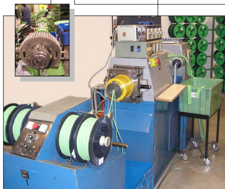
Extruder: zur Herstellung von Halbzeugen
